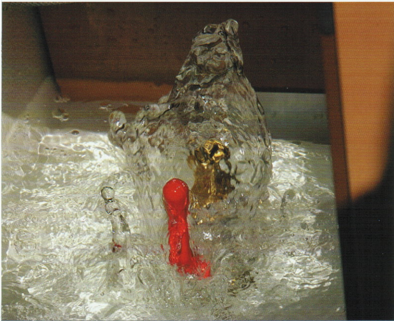
Der Rumpfdurchlaß wurde für den Unsinkbarkeitstest geöffnet.
